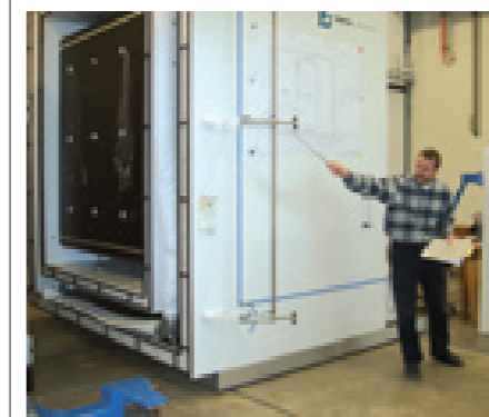
Démonstration de la station de mesure ultraprécise de l'EMPA pour tous les types de fenêtre.
