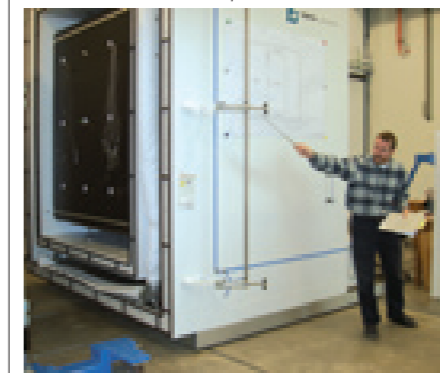
Demonstration der hochpräzisen EMPA U w -Messstation für alle Fenstertypen.
